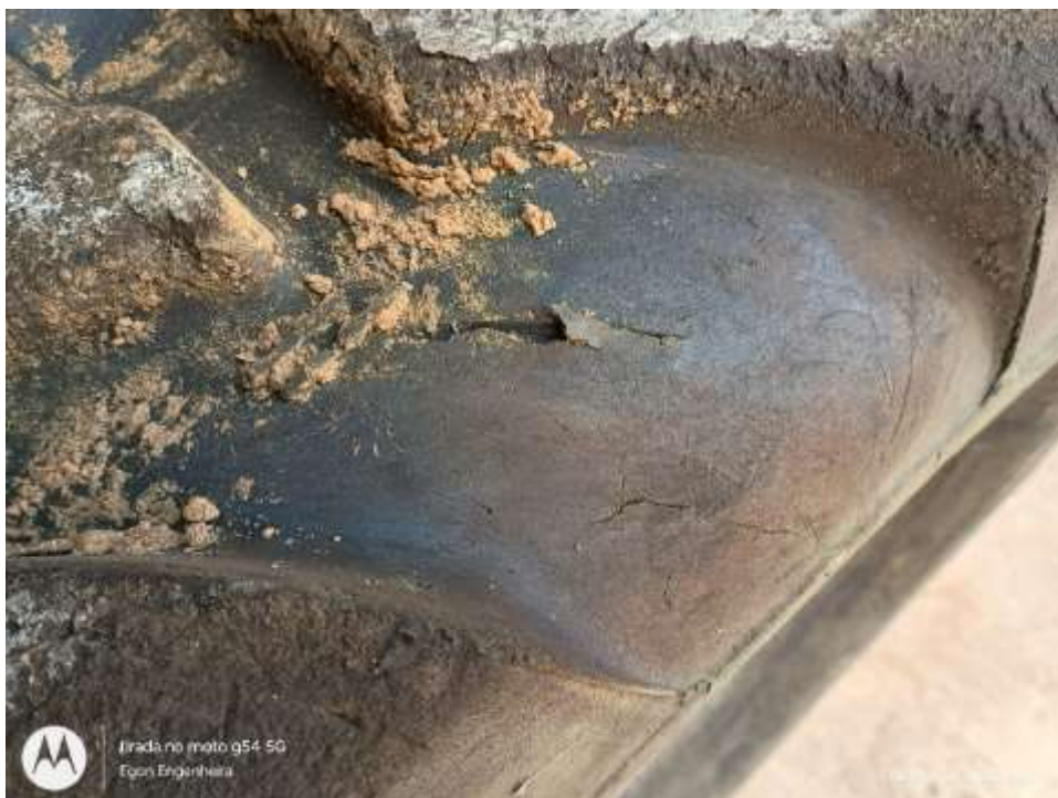
Pneus com altura de garras suficientes, mas com rasgo
